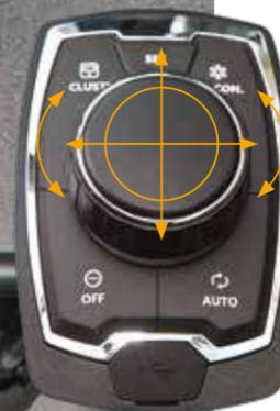
L'accélérateur, la commande à distance du climatiseur et le tableau de bord peuvent être commandés à l'aide du **contrôleur haptique à bascule** approprié.
