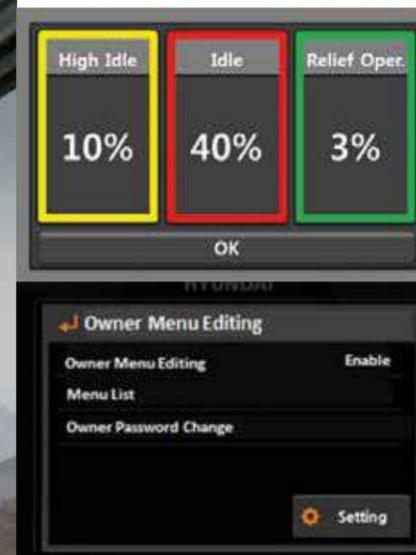
Les **fonctions de menu** peuvent être définies par le propriétaire de la machine, qui peut également permettre ou restreindre l'accès aux utilisateurs de la machine à l'aide d'un mot de passe pour verrouiller ou déverrouiller la liste des paramètres de la machine.
