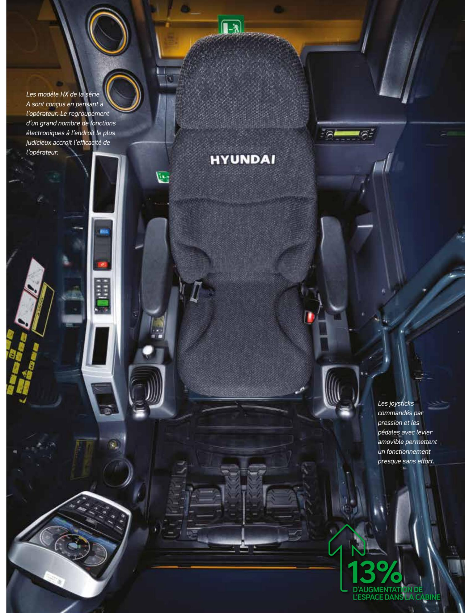
Les joysticks commandés par pression et les pédales avec levier amovible permettent un fonctionnement presque sans effort.
